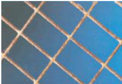
Běžná pozinkovaná síť na konci zkušebního období 5 let.
